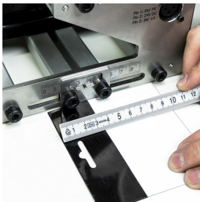
Einfaches Einstellen der Heftlinie. Gewünschte Position am Werkstück messen und auf die Skala des Z273-X übertragen.
